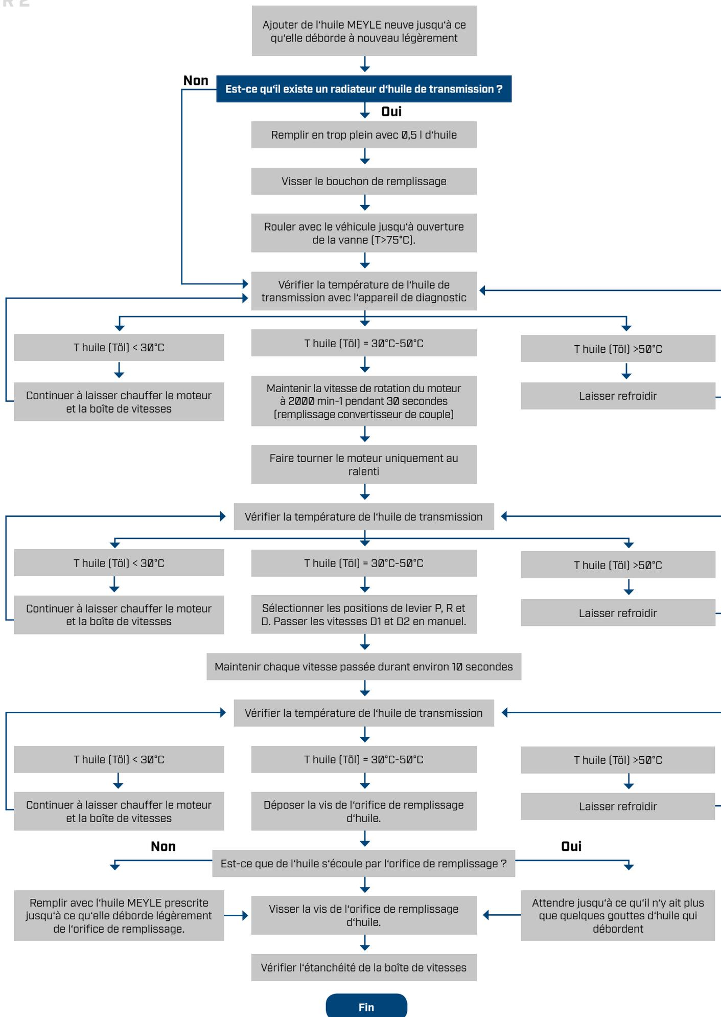
**Attention : Une vanne de dérivation ouvrant ou fermant le circuit d'huile du radiateur d'huile peut être montée sur certains types de transmissions. Par conséquent, la température de l'huile de transmission doit atteindre au moins  $75^{\circ}\text{C}$  pendant une durée d'essai routier suffisante. Après l'essai routier, laisser refroidir la boîte de vitesses, revérifier le niveau d'huile et corriger le cas échéant.**
