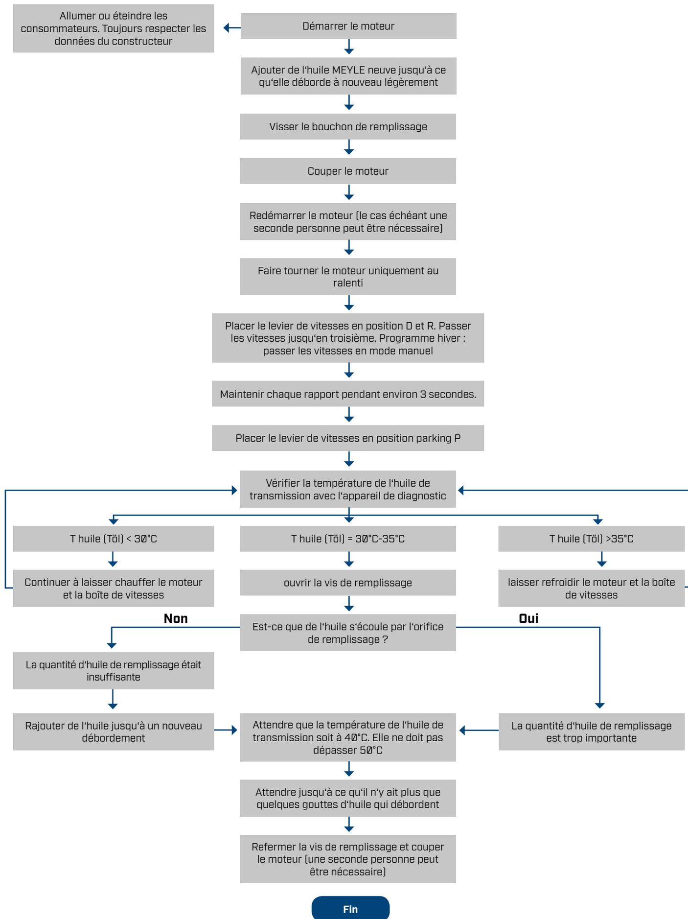
**Attention : Une vanne de dérivation ouvrant ou fermant le circuit d'huile du radiateur d'huile peut être montée sur certains types de transmissions. Par conséquent, la température de l'huile de transmission doit atteindre au moins 75 °C pendant une durée d'essai routier suffisante. Après l'essai routier, laisser refroidir la boîte de vitesses, revérifier le niveau d'huile et corriger le cas échéant.**
